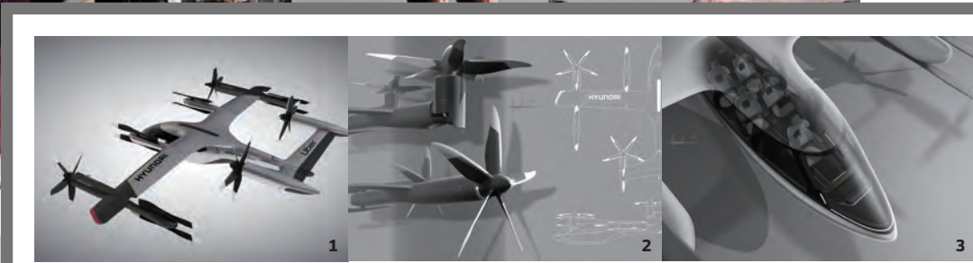
1, 2 현대자동차가 우버와 함께 개발한 전기 항공기 렌더링. CES에는 실물 크기의 프로토타입을 공개했다. 8개의 전기모터가 90° 전환되는 틸트 로터 항공기로 수직이착륙이 가능하다. 이착륙에는 8개를 모두 사용하지만 순항 중에는 에너지 효율을 높이기 위해 4개만 사용한다. 3 현대 PBV S-A1은 파일럿이 별도로 존재하는 항공기다. 우버와 함께 개발했다는 점이 의미심장하다. 가까운 시점에 자율비행은 무리라고 판단한 것일까?
