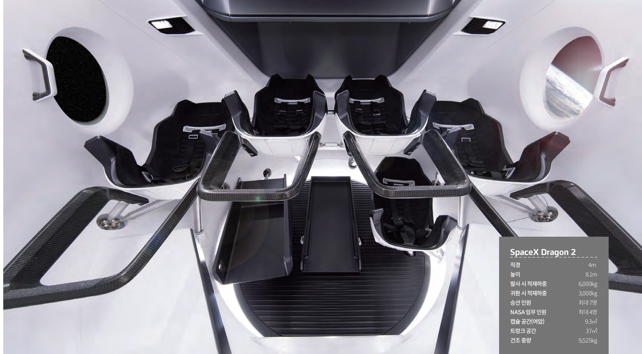
스페이스X가 2015년 공개한 크루드래곤의 캡슐 내부. 최대 7명이 탑승 가능한 공간이라는 점은 같지만 올해 유인 시험 비행에 들어갈 우주선은 세부적인 면에서 약간 변경됐다.
