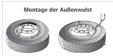
Reifen ohne Schlauch verwenden, um die Arbeit abzuschließen. Während der Reifenmontage übermäßige Kraftanstrengungen vermeiden, keine schweren Werkzeuge verwenden sowie nicht mit Werkzeugen wie z. B. einem Hammer auf die Felge schlagen.
