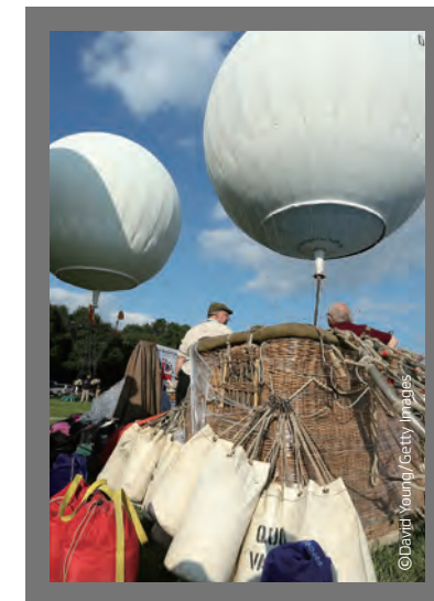
열기구와 달리 가스기구는 곤돌라 사방에 밸러스트를 주렁주렁 달고 이륙한다. 부력이 더 필요할 때, 즉 고도를 높여야 할 때 밸러스트를 떨어뜨려 무게를 줄인다.
